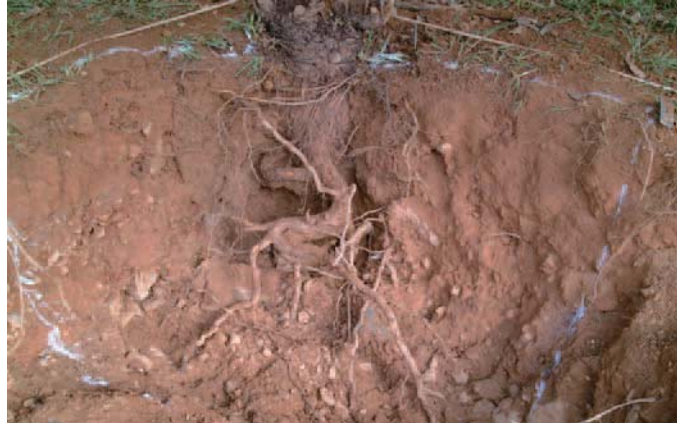
写真-2.28 植栽基盤の整備不良（固結土壌）が原因の根系伸長不良（モンパノキ）
