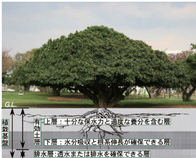
図 - II .4 植栽基盤の概念図
