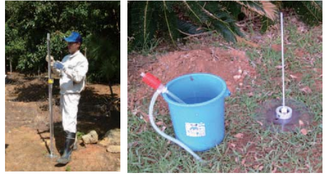
(右:長谷川式土壤貫入計、左:長谷川式土壤透水計)
