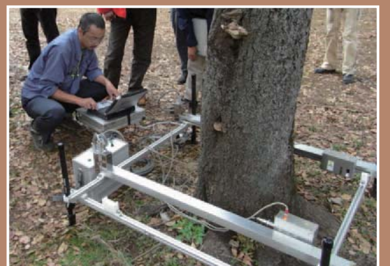
<樹木健全度調査（腐朽診断）>
