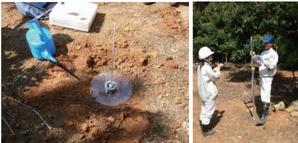
写真 - II .9 現場における土壌物理性の測定（左：透水測定、右：硬度測定）
